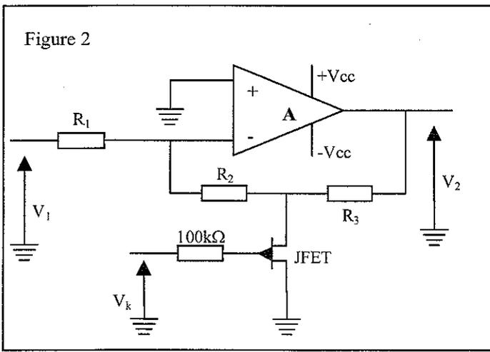
c) L'amplificateur est alimenté de façon à pouvoir fournir sans distorsion une tension de sortie alternative  $V_2 = \pm 10 \text{ V}$ . Or le transistor JFET ne peut être considéré comme une résistance linéaire que si la tension sur son drain  $V_{DS}$  ne dépasse pas  $\pm 100 \text{ mV}$  (limites de non distorsion).
