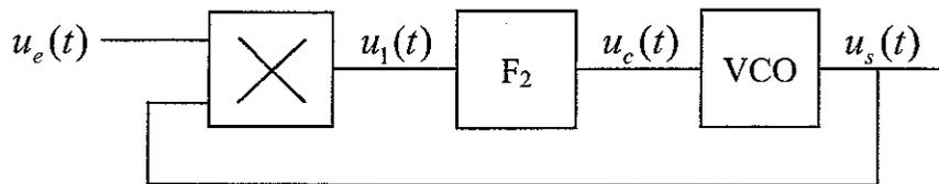
Le filtre passe-bas  $F_2$  possède une transmittance égale à 1 pour les fréquences très inférieures à  $f_p$ , l'oscillateur commandé en tension VCO délivre un signal sinusoïdal d'amplitude constante  $E$  et de pulsation  $\omega_s$  proportionnelle à la tension de sortie du filtre  $F_2$ .
