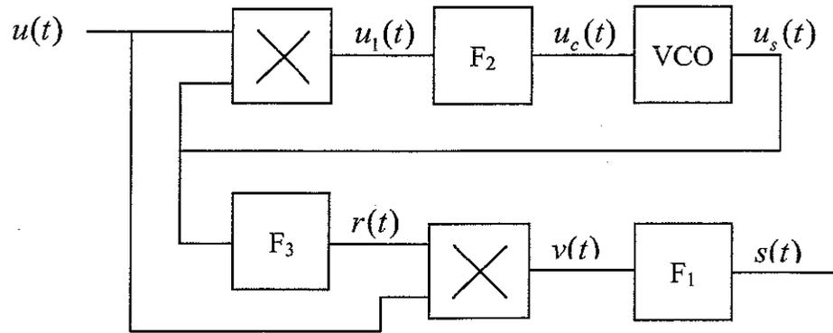
Quelles doivent être les caractéristiques du quadripôle  $F_3$  pour obtenir  $r(t)$  à partir de  $u_s(t)$  ?
