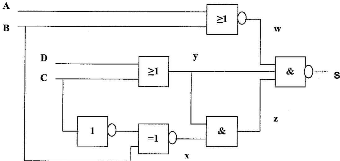
A,B,C et D sont des variables binaires d'entrée et le schéma est composé d'opérateurs logiques (ET, OU, OU EXCLUSIF et INVERSEUR).
